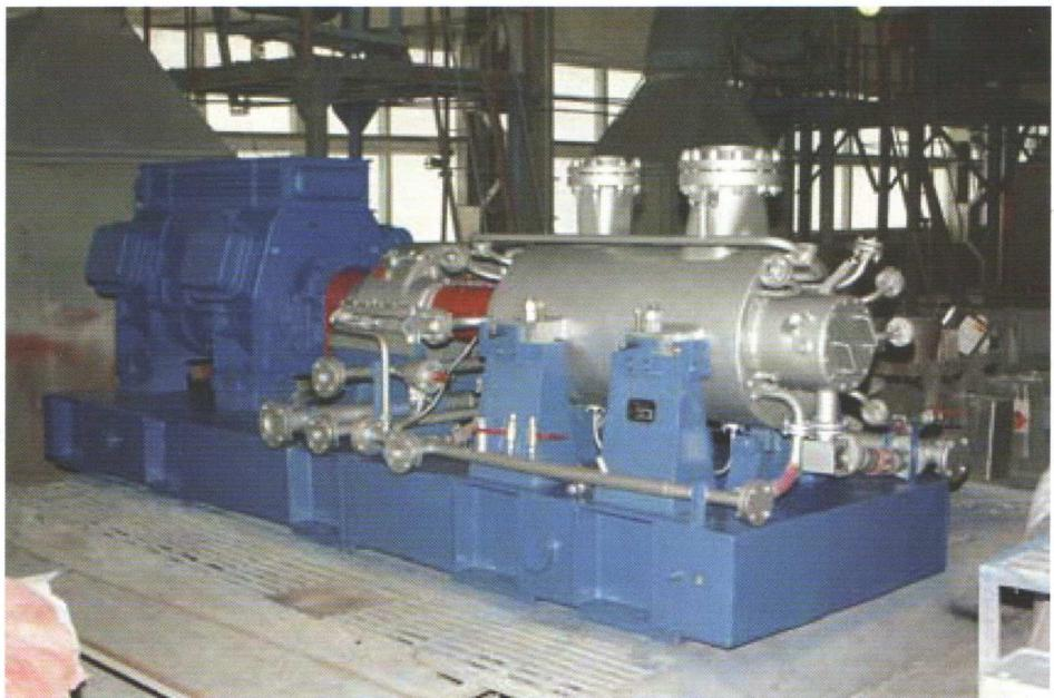
**Центробежная компрессорная установка с сухими газодинамическими уплотнениями 2ГД2 - 16/27-37УХЛ1 для циркуляции водородосодержащего газа в блоке изомеризации нефти**
