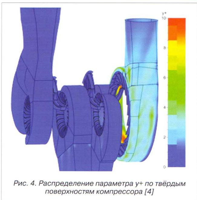
Рис. 4. Распределение параметра  $y^+$  по твёрдым поверхностям компрессора [4]
