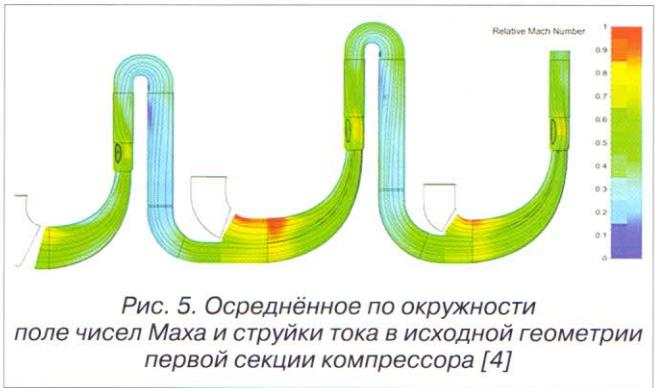
Рис. 5. Осреднённое по окружности поле чисел Маха и струйки тока в исходной геометрии первой секции компрессора [4]
