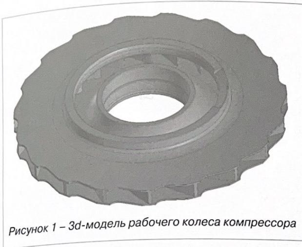
Рисунок 1 – 3d-модель рабочего колеса компрессора
