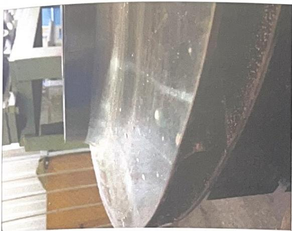
Рисунок 3 – Сварное рабочее колесо после проведения разгонных испытаний при частоте вращения 16700 об/мин
