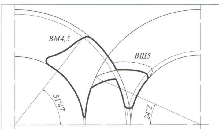
Рис. 3. Схема окна нагнетания с рассогласованными передними кромками
