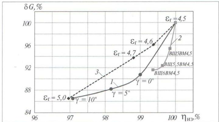
Рис. 4. Сравнение зависимости коэффициентов неравномерности подачи  $\delta G$  и изотермического КПД  $\eta_{iz}$  от  $\varepsilon_r$  для модификаций со скошенными передними кромками (1), с рассогласованными передними кромками (2) и с окнами, обеспечивающими различную степень сжатия (3)
