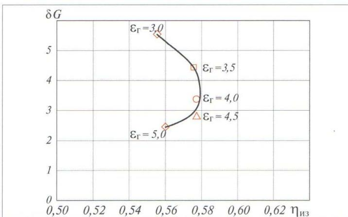
Рис. 1. Зависимости коэффициента неравномерности подачи  $\delta G$  и изотермического КПД  $\eta_{iz}$  от геометрической степени сжатия  $\varepsilon_r$  при отношении давлений  $\pi = 9$
