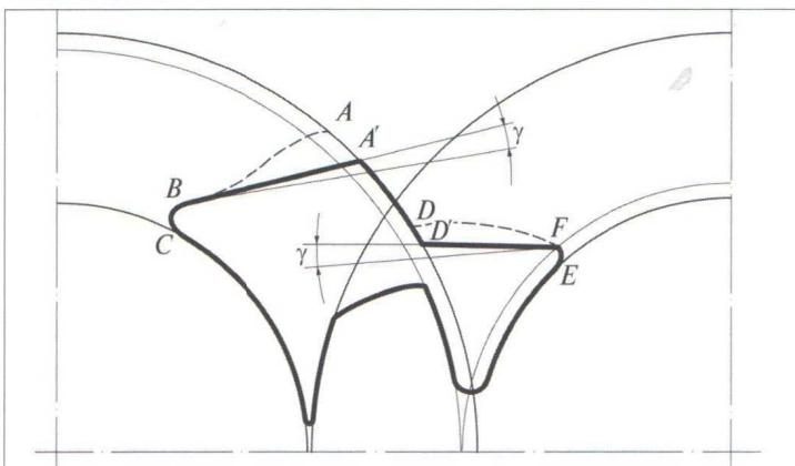
Рис. 2. Схема окна нагнетания со скошенными передними кромками
