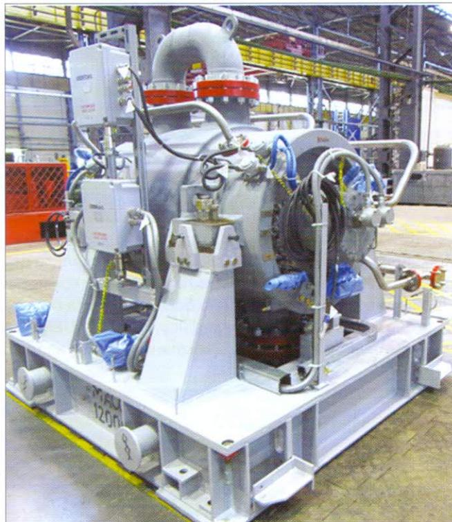
Рис. 2. Компрессор на раме для компрессорной установки 4ГЦ2-55/10-40 У.1
