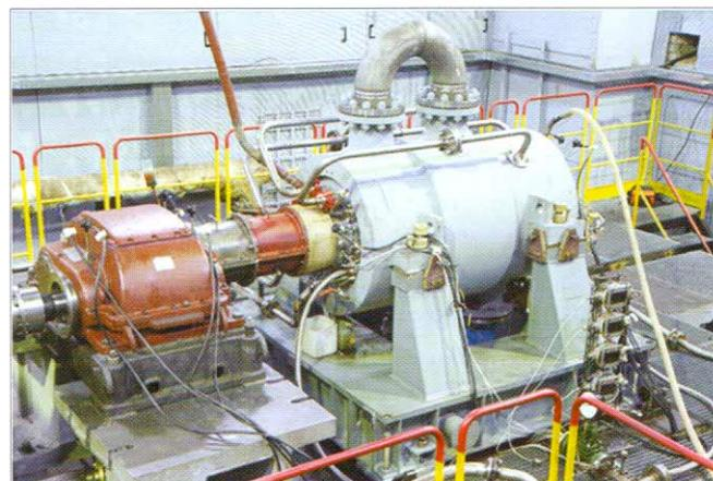
Рис. 3. Испытание компрессора на раме на испытательном стенде ПАО «Казанькомпрессормаш»
