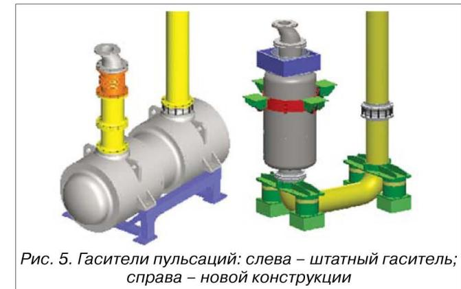
Рис. 5. Гасители пульсаций: слева – штатный гаситель; справа – новой конструкции
