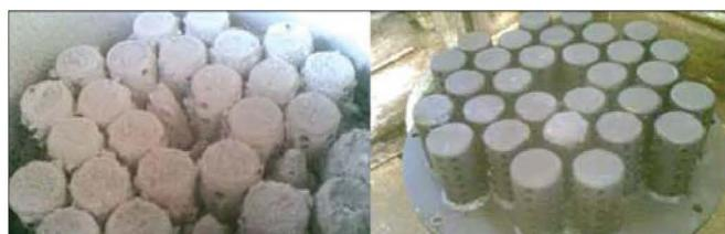
Рис. 6. Образование кристаллов гидрокарбонат аммония на элементе глушителя: справа - до образования кристаллов
