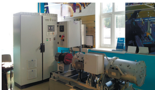
Рис. 5. Стенд-имитатор с САУ ЭМП «Неман-100»
